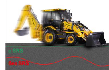
SRS-система стабилизации ковша
